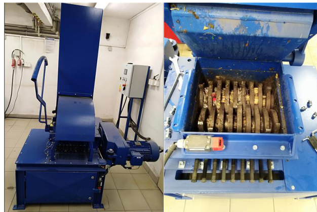
Obrázok 3: Homogenizácia vzoriek pomocou vılcového mlyna
